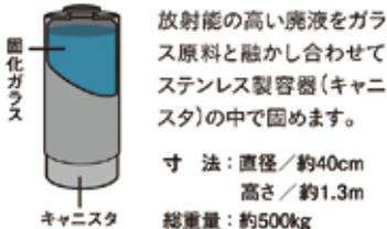
放射能の高い廃液をガラス原料と融かし合わせてステンレス製容器(キャニスタ)の中で固めます。寸法：直径/約40cm 高さ/約1.3m 総重量：約500kg
