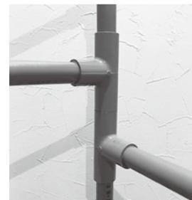
②管と継手をゴムハンマーで打って繋げていきます。強く打てば塩ビ用接着剤はなくても大丈夫ですが、動かした時に外れないように使っています。
