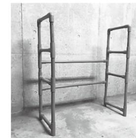
③アイアン塗料を塗る前に、プライマーで下塗りをします。下塗りが乾いたら、アイアン塗料を刷毛で軽くたたくように塗っていきます。ちょっと凹凸があるくらいのほうが鉄っぽい質感がでます。
