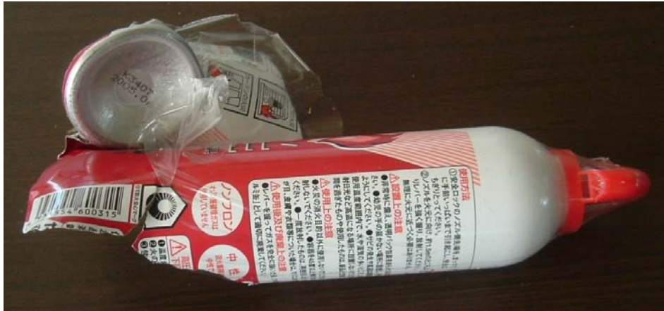
図 5. 破裂した回収対象製品
